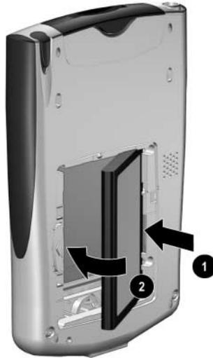
4. Vuelva a colocar la tapa de la batería insertando primero las lengüetas de la tapa de la batería ❶ y, a continuación, cierre la tapa y encájela ❷.
