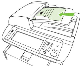
2. Faites glisser la pile dans le BAA afin de la bloquer en position.
