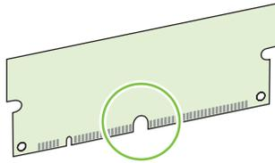
5. 握住 DIMM 的邊緣，以斜向角度將 DIMM 上的槽口與 DIMM 插槽對齊。
