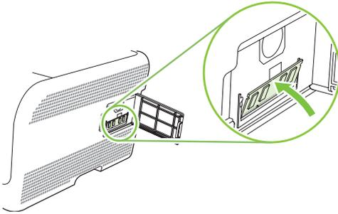
6. 向下推 DIMM，直至兩個卡鎖卡入 DIMM。如果安裝正確，則看不到金屬接點。
