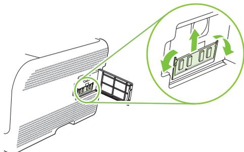
4. 從防靜電包裝中取出新的 DIMM，然後找到 DIMM 底部邊緣上的對齊凹槽。
