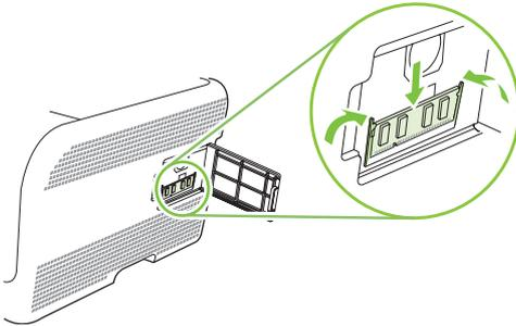
**附註：** 如果 DIMM 不易插入，請確保 DIMM 底部的凹槽對準插槽中的插腳。如果 DIMM 仍然插不進去，請確定所使用的 DIMM 類型是否正確無誤。
