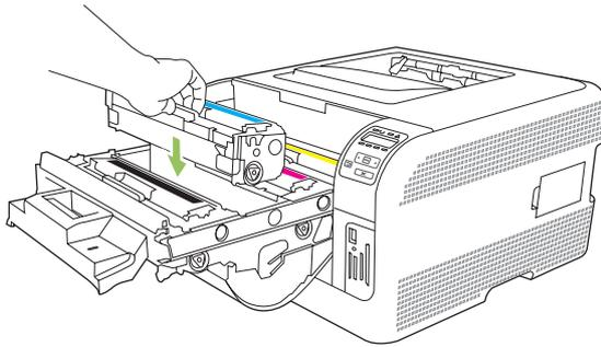
7. 將碳粉匣左側標籤向上拉就能完全撕除密封膠帶。丟掉密封膠帶。
