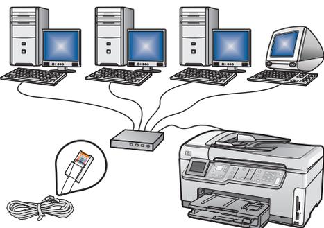
HP All-in-One와 네트워크 간의 Ethernet 케이블 연결을 원할 경우 **섹션 C**의 지침을 사용하십시오. 필요한 장치: 라우터 및 Ethernet 케이블.
