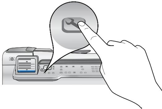
b. HP Photosmart의 **Setup (설치)** 버튼을 누릅니다.
