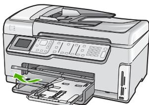
2. Inserte la pila de tarjetas en la bandeja de fotografías con el borde corto primero y la cara de impresión hacia abajo. Deslice la pila hasta que se detenga.
