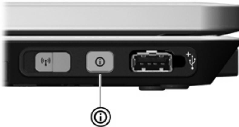
Beim erstmaligen Drücken der Info Center-Taste wird das Info Center geöffnet. Es ermöglicht Ihnen, die voreingestellten Softwarelösungen zu öffnen. Wenn Sie diese Werkseinstellung der Info Center-Taste nicht verwenden möchten, können Sie die Taste auch neu programmieren, um eine der folgenden Aktionen auszuführen:
