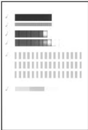
Les coches permettent de vérifier que la cartouche d'impression est correctement installée et qu'elle fonctionne normalement.
