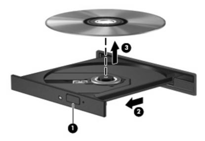
3. Fermez le chargeur de disques et placez le disque dans un étui de protection.
