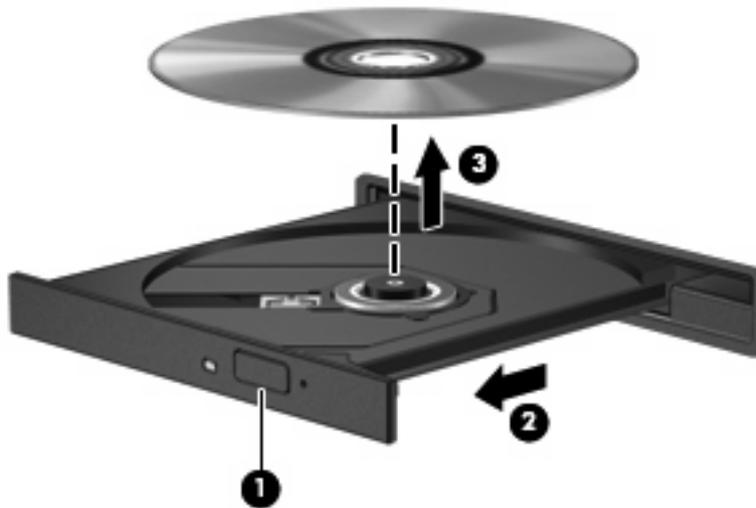
3. Fermez le chargeur de disques et placez le disque dans un étui de protection.
