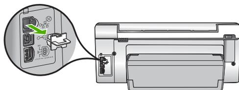
2. HP All-in-One 背面の Ethernet ポートに Ethernet ケーブルを接続します。
