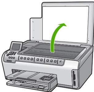
2. 印刷面を下にしてガラス面の右下隅に合わせて原稿をセットします。
