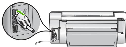
3. Ethernet ケーブルのもう一方の端を Ethernet ルーター、スイッチまたはワイヤレス ルーターの空いているポートに接続します。
