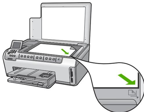
2. 印刷面を下にしてガラス面の右下隅に合わせて原稿をセットします。
