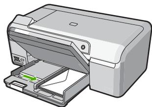
4. 横方向用紙ガイドを、封筒に当たって止まるまでスライドさせます。メイン給紙トレイに用紙を入れすぎないようにしてください。封筒の束がきちんとメイン給紙トレイの中に収まり、横方向用紙ガイドの上端より低いことを確認してください。
