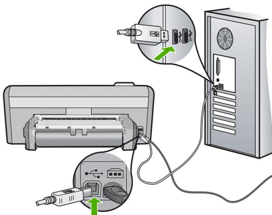
ソフトウェアのインストールと USB ケーブルの接続については、HP Photosmart 付属の『セットアップガイド』を参照してください。
