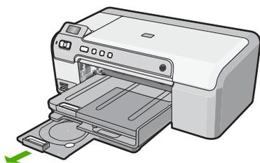
2. インクジェットで印刷可能なメディアを、印刷面を上にして CD/DVD ホルダーにしっかりと固定します。CD/DVD はホルダーの端の矢印に合わせてリングの上に置いてください。
