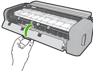
5. 両面印刷モジュールを元に戻します。パチンと音がするまでゆっくり押し込みます。
