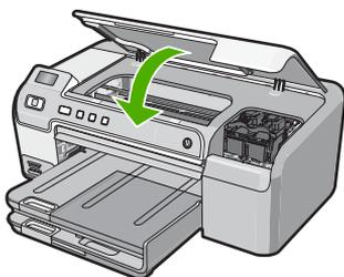
新しいプリントカートリッジを取り付けると、プリントカートリッジ調整ページが印刷されます。
