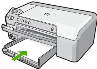
△ **注意** メイン給紙トレイに用紙をセットするときは、HP Photosmart が停止し、静かになっていることを確認してください。HP Photosmart がプリントカートリッジをクリーニングしていたり、その他のタスクを実行していると、用紙が途中で止まり、正しく装着されない場合があります。用紙を手動で押し込むと、HP Photosmart から空白のページが排紙されます。
