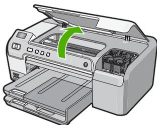
3. インクホルダーが停止して静かになってから、プリントカートリッジを静かに押して外します。
