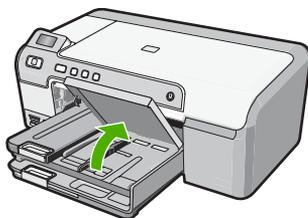
2. 短いほうの辺を奥に、印刷面を下にしてフォト用紙の束をフォトトレイに挿入します。フォト用紙の先端が止まるまで奥に差し込んでください。お使いのフォト用紙にミシン目付きのタブがある場合は、そのタブが自分のほうに向くようにフォト用紙をセットしてください。
