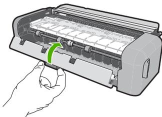
5. 両面印刷モジュールを元に戻します。パチンと音がするまでゆっくり押し込みます。
