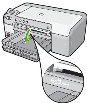
印刷可能なディスクを、印刷面を上にして CD/DVD ホルダーにセットしていることを確認します。ホルダー上の白線が CD/DVD トレイ上の白い線と重なるまで、CD/DVD ホルダーを CD/DVD トレイに押し込みます。矢印の付いているホルダーの先端が最初に CD/DVD トレイの中に入ります。
