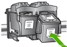
9. Sluit het vak met de printcartridge.
