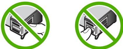
**Hinweis** Gehen Sie mit den Druckpatronen sorgsam um. Wenn Sie die Druckpatronen fallen lassen oder anderweitig beschädigen, können vorübergehend Druckprobleme oder dauerhafte Schäden entstehen.
