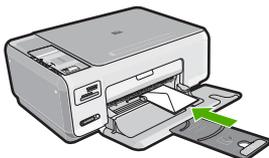
3. Deslice la guía de anchura del papel hacia dentro hasta que se detenga en la pila de sobres.
