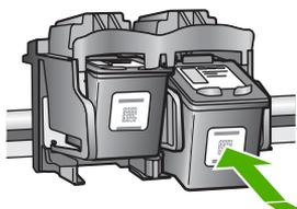
3. Ulangi langkah 1 dan 2 untuk kartrij cetak triwarna di sisi kiri.
