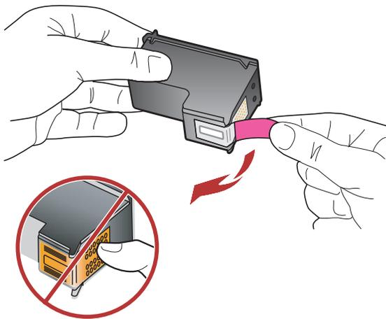
**DE** Ziehen Sie die Schutzfolie von beiden Druckpatronen ab.
