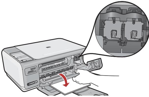
**DE** Öffnen Sie die Patronenklappe. Vergewissern Sie sich, dass der Druckpatronenwagen nach rechts gefahren wird. Sollte dies nicht der Fall sein, schalten Sie das Gerät aus und danach wieder ein.
