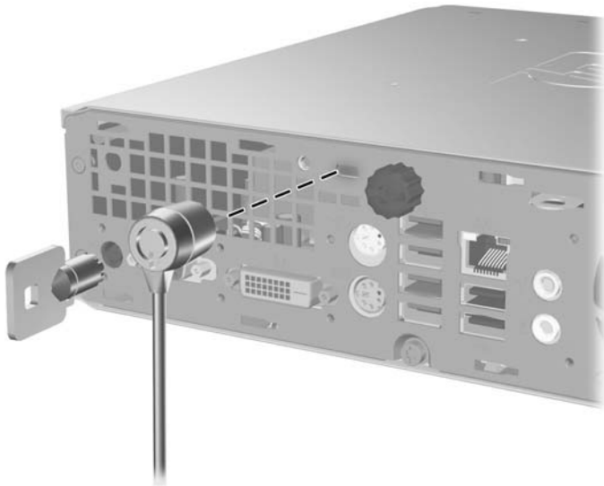
图 C-2 已安装端口盖时安装缆锁
