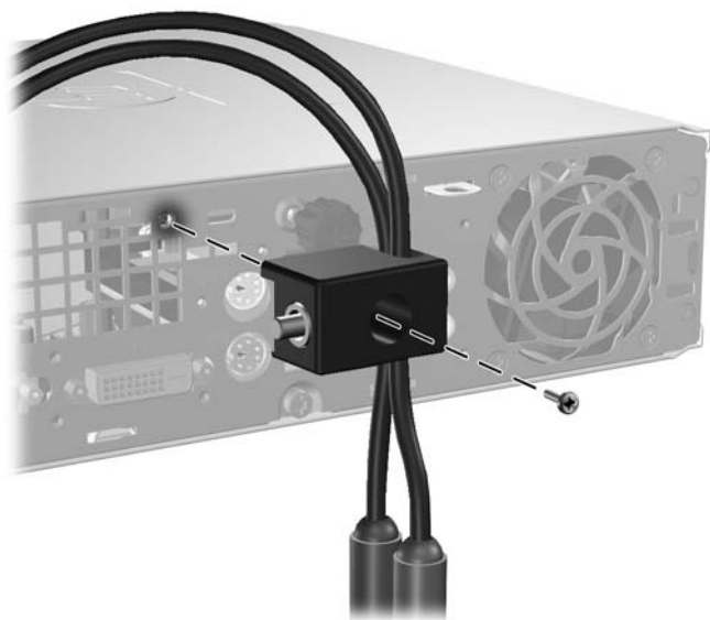
图 C-6 将钳锁固定到机箱上
