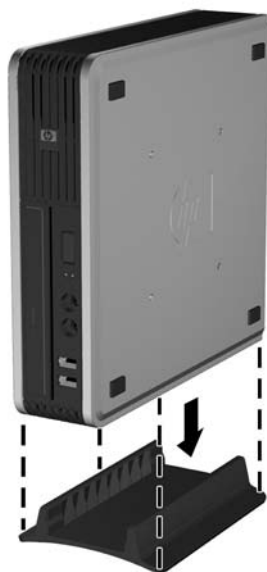
图 1-7 将计算机放到底座上
