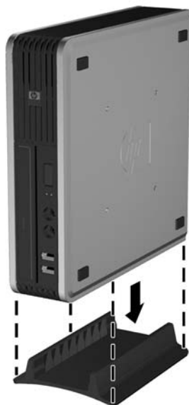
Obrázek 1-7 Vložení počítače do podstavce
