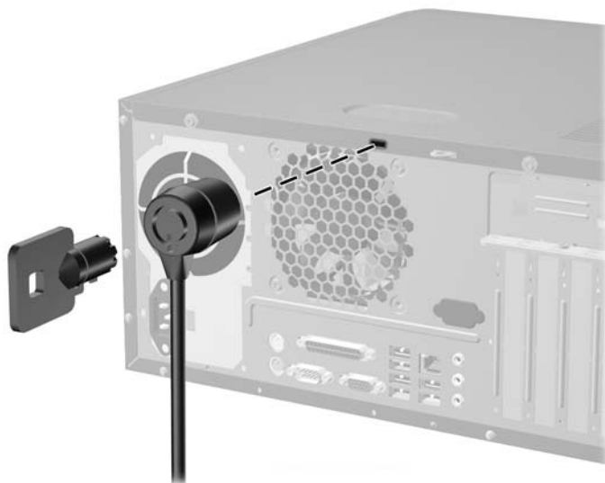
Figure 2-13 Installation d'un dispositif antivol
