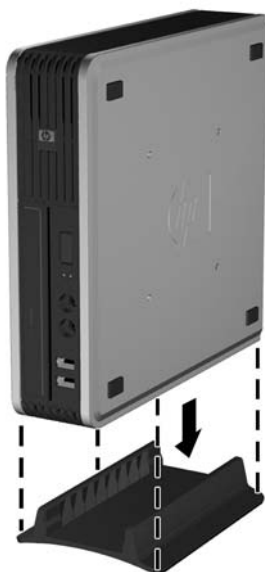
Εικόνα 1-7 Τοποθέτηση του υπολογιστή στη βάση
