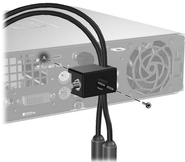
Εικόνα Γ-6 Σύνδεση της κλειδαριάς στο πλαίσιο
