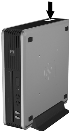
Slika 1-5 Mjesto serijskog broja i identifikacijskog broja računala
