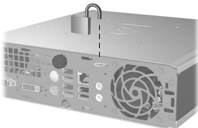
Slika C-3 Ugrađivanje sigurnosnog lokota
