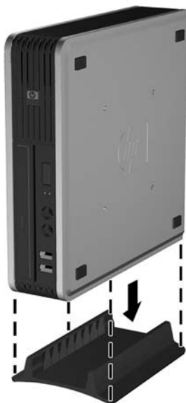
Slika 1-7 Postavljanje računala na stalak
