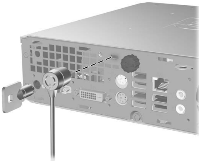
圖示 C-1 沒有連接埠外蓋時安裝纜線鎖
