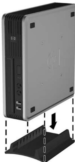
図 1-7 コンピュータをスタンドに固定
