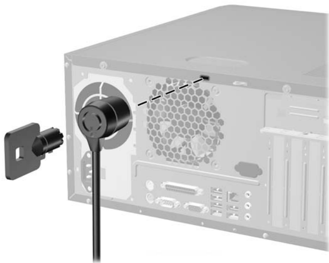
図 2-13 セキュリティ ロックの取り付け
