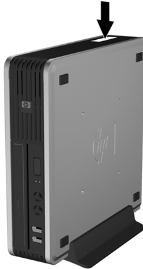
Afbeelding 1-5 Locatie van serienummer en productidentificatienummer
