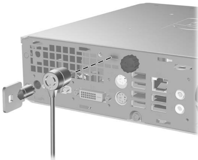
Figur C-1 Installere en vaierlås uten portdeksel
