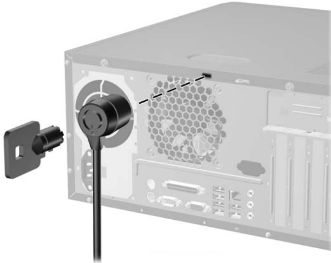
Obrázok 2-13 Inštalácia bezpečnostného zámku
