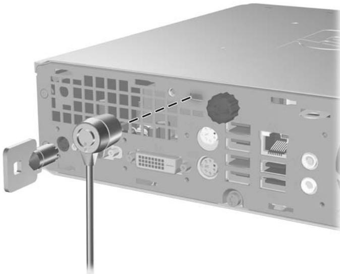
**Figura C-2** Instalación de un cable con cubierta de puerto instalada
