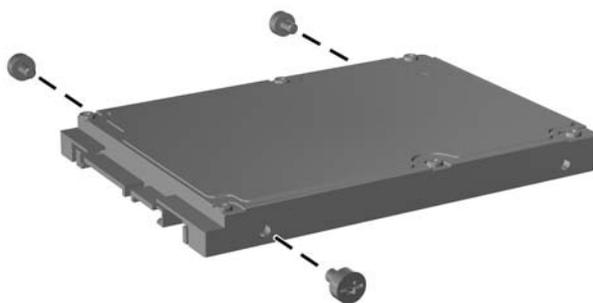
13. Alinee los tornillos de guía con las ranuras del soporte y deslice la nueva unidad de disco duro en el soporte (1). A continuación, vuelva a instalar el tornillo de guía en el lado delantero izquierdo del soporte para fijar la unidad en el soporte (2).
