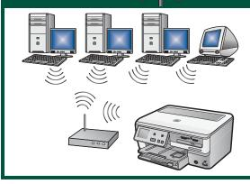
如果要在 HP All-in-One 和网络之间进行无线(802.11b 或 802.11g)连接,请参照 B 部分的说明。所需设备:无线路由器。
