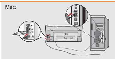
注意:如果没有随附 USB 电缆, 请单独购买。 a.将 USB 电缆的一端连接到 HP All-in-One 背面的端口,然后将另一 端连接到计算机的任意一个 USB 端口。
