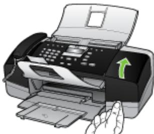
3. После полной остановки каретки слегка нажмите на картридж и извлеките его. При замене трехцветного картриджа (только в HP Officejet J3600) извлеките картридж из левого гнезда.
