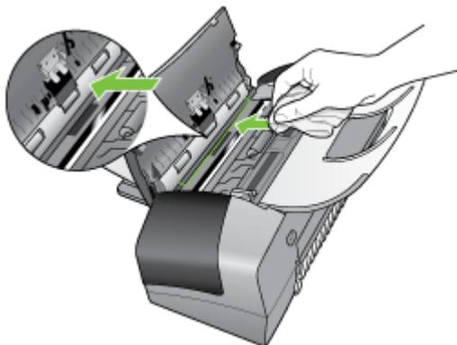
4. Если не удастся достаточно хорошо очистить пластину, повторите описанные выше шаги с использованием изопропилового (протирачного) спирта, затем тщательно протрите подложку влажной тканью для удаления малейших следов спирта.
