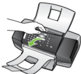
3. Очистите белую пластину мягкой тканью или губкой, слегка смоченной теплой водой с мягким мылом.
