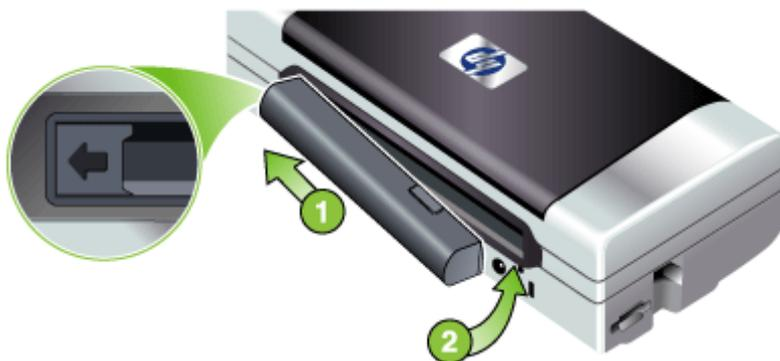
2. Spingere la batteria nel suo vano fin quando non si assesta in posizione.
