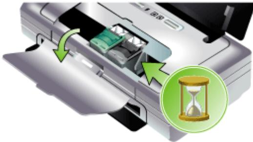
3. 向上抬起列印墨水匣固定鎖以將它打開，然後輕輕地將列印墨水匣從安裝底槽中取出。
