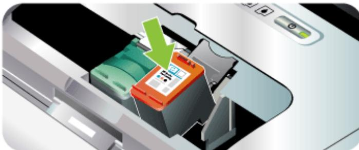
5. 關上列印墨水匣固定鎖。如果墨水匣有正確地裝入，則關上固定鎖的時候，會將墨水匣輕輕地壓入安裝底槽。按一下固定鎖，確定它有平坦地蓋在墨水匣上面。
