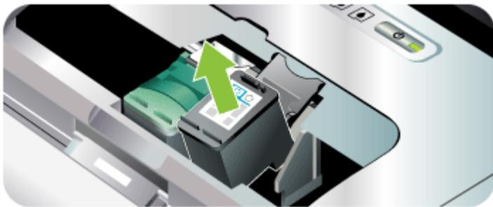
3. 將列印墨水匣置於密閉的塑膠容器以避免乾掉，並置於一旁。除非 HP 客戶支援專線服務員指示，否則請勿將印字頭連同裝置一起送修。
