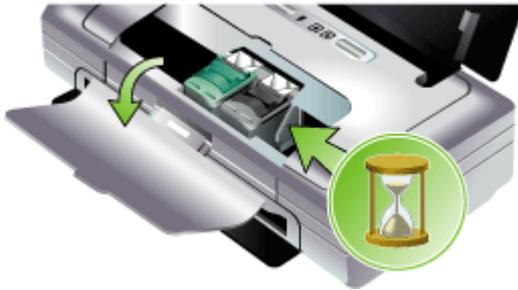
2. 向上抬起列印墨水匣固定鎖以將它打開，然後輕輕地將列印墨水匣從安裝底槽中取出。
