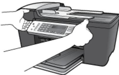
4. Guarde a máscara do painel de controle. Não envie a máscara do painel de controle junto com o dispositivo.
