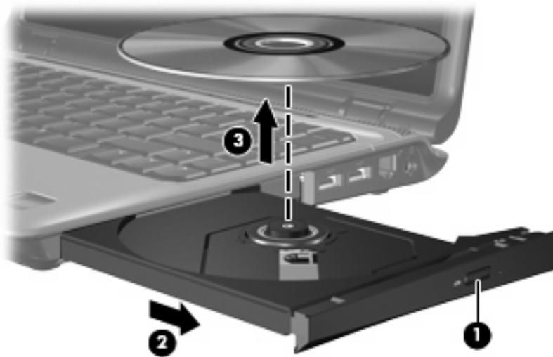
3. Fermez le chargeur de disques et placez le disque dans un étui de protection.
