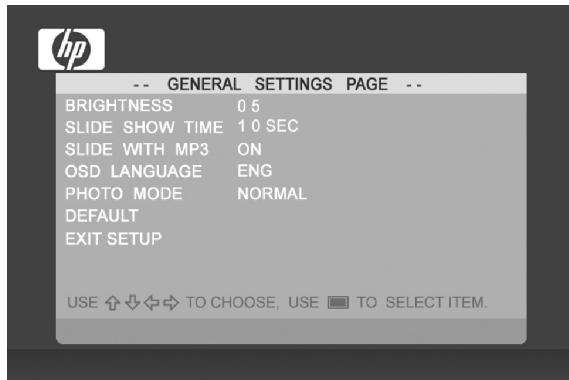
**BRIGHTNESS(LUMINOSITÀ):** Regola la luminosità da -10 a +10
