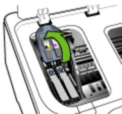
4. Levante a alça do cabeçote de impressão e use-a para puxar o cabeçote para fora do slot.
