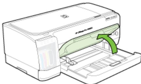
2. Insira a mídia com o lado de impressão voltado para baixo na extensão direita da bandeja. Verifique se a pilha de mídia está alinhada com as extremidades direita e traseira da bandeja e não excede a marcação de linha da bandeja.
