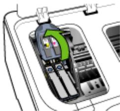
4. Levante a alça do cabeçote de impressão que deseja substituir e retire-o de seu slot.
