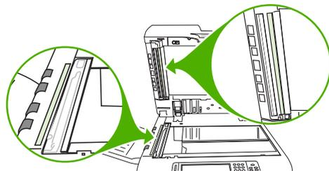
6. 糸くずの出ない清潔な布を湿らせて、ADF の裏張り部分と校正ストリップを拭きます。
