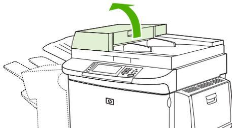
2. 上部の ADF のガラス ストリップを緩めるラッチを見つけます。ラッチを左へ押して引き下げると、ガラス ストリップの内部が現れます。
