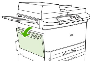
3. 緑色のレバーを押して、ユニットが止まるまで引き出して、両面印刷アクセサリを取り外します。
