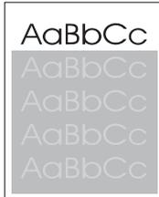
ページの上部に印刷される黒いイメージが、ページの下方にグレーで繰り返し印刷される場合は、前回のジョブからトナーが完全に消去されていない可能性があります (繰り返し印刷されるイメージは、それが印刷されるフィールドよりも薄い場合もあれば濃い場合もあります)。
