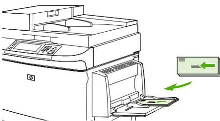
3. 封筒を曲げない程度にガイドを封筒の束に合わせます。ガイドのタブの下に封筒が収まっていることを確認してください。
