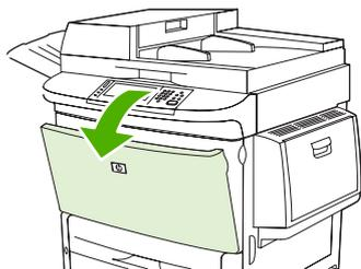
6. 両面印刷アクセサリ内の用紙の状態を確認し、MFP から用紙を引き出して取り除きます。用紙が破れないように注意してください。
