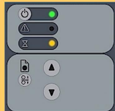
C'est normal. Le voyant d'attente reste allumé pendant l'étalonnage pour indiquer que vous ne devez pas retirer ni déplacer l'original au cours de cette procédure. Pendant l'étalonnage de base, aucune entrée n'est possible à partir du panneau de commande.
