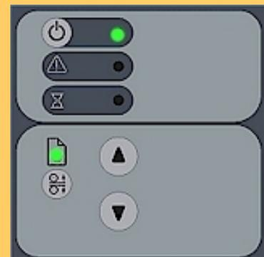
Le voyant de papier prêt s'allume en vert lorsqu'un support fin normal a correctement été engagé dans la fente d'insertion. Il reste vert lorsque ce support avance pour se mettre en position de lancement de la numérisation.
