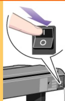
À l'arrière du scanner, branchez le câble d'alimentation, puis basculez le commutateur d'alimentation sur la position de mise sous tension. Le scanner lance une procédure d'autotest qui démarre par la séquence d'initialisation (voir point suivant).
