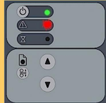
Le voyant de diagnostic indique l'état des résultats de l'autotest du scanner. Si le voyant de diagnostic est éteint, cela signifie que les procédures d'autotest du scanner n'ont détecté aucune erreur.
