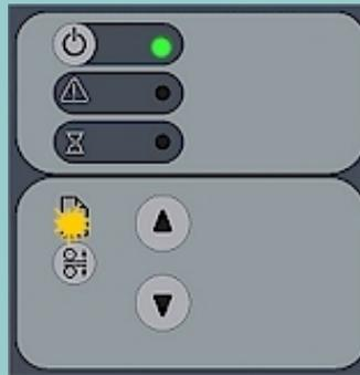
2. Appuyez sur la touche d'avance du papier (flèche vers le haut) et maintenez-la enfoncée pour relever la platine de pression jusqu'à ce qu'il y ait suffisamment d'espace pour insérer l'original épais. Insérez ensuite l'original épais avec soin pour qu'il ne dévie pas de sa trajectoire de numérisation.
