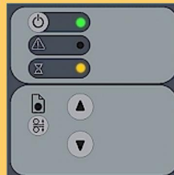
Après une mise sous tension électrique de l'équipement (via le commutateur d'alimentation), à la fin de la séquence d'initialisation, le voyant d'alimentation (vert) et le voyant d'attente (jaune) restent allumés, alors que les autres voyants s'éteignent. Cette configuration indique que le scanner est en train d'exécuter sa procédure d'ajustement automatique des profils de ses voyants, de la liaison des appareils et des points noirs/blancs.
