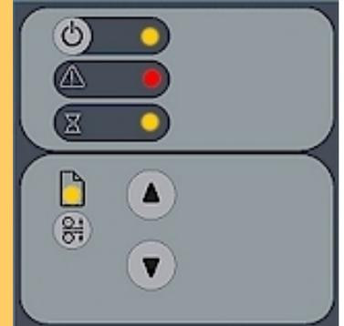
Lorsque vous démarrez le scanner à froid en basculant le commutateur d'alimentation à l'arrière du scanner sur la position de mise sous tension, il exécute sa séquence d'initialisation. TOUS les voyants sont allumés, comme l'indique la figure ci-dessus.
