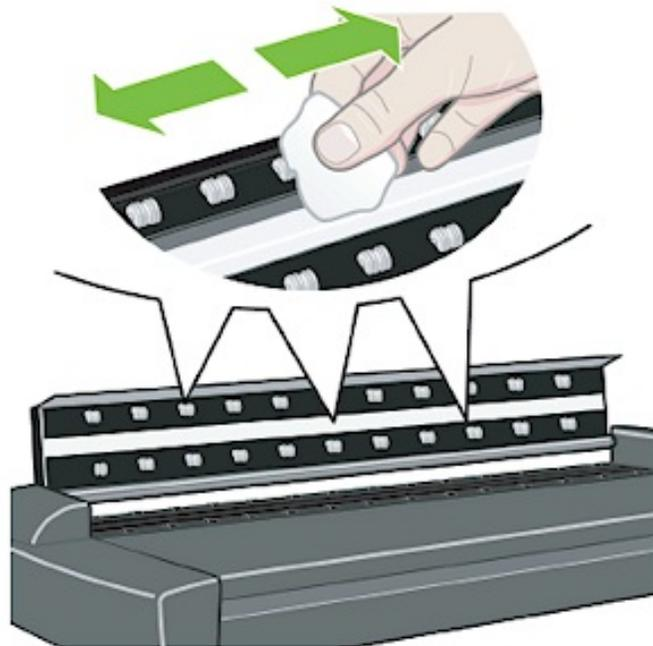
8. Nettoyez également la surface du scanner pour qu'aucune poussière ou particule ne soit entraînée dans la zone de numérisation avec l'original.
