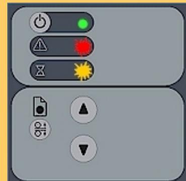
Si les voyants de diagnostic et d'attente clignotent en même temps, il se peut que la zone de numérisation ait besoin d'être nettoyée et les appareils étalonnés. Consultez les [procédures de maintenance](#).
