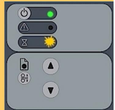
Si le voyant d'attente clignote (et que le voyant de diagnostic est éteint), le scanner a besoin d'exécuter une procédure d'ajustement automatique, mais il n'y parvient pas. Cette procédure est nécessaire pour conserver des conditions internes optimales et stables.
