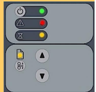
À la fin de la séquence d'initialisation, le voyant d'alimentation passe au vert, tandis que les autres voyants restent dans le même état (allumés), comme la figure ci-dessus. À partir de cette étape, le scanner passe à la procédure d'ajustement automatique (phase 3 du démarrage).
