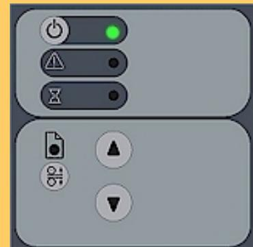
Lorsque le voyant d'attente s'éteint (et que seul le voyant d'alimentation reste allumé en vert), la procédure d'ajustement automatique est terminée et le scanner est prêt pour des tâches de numérisation.
