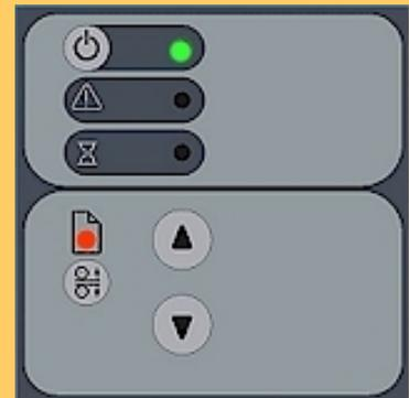
Le voyant de papier prêt s'allume en rouge si la platine de pression est réglée pour un support épais (la platine est alors relevée), mais qu'aucun support n'est détecté dans le scanner.
