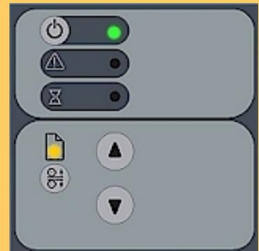
Le voyant de papier prêt s'allume en jaune lorsque le scanner est prêt pour une tâche de numérisation avec un support épais. La platine de pression a été abaissée et le support est correctement positionné dans le scanner.
