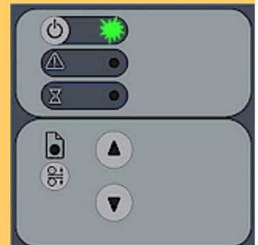
Le voyant d'alimentation vert clignote juste avant la mise automatique hors tension du scanner s'il a atteint l'heure définie (dans WIDSystem) de mise hors tension.
