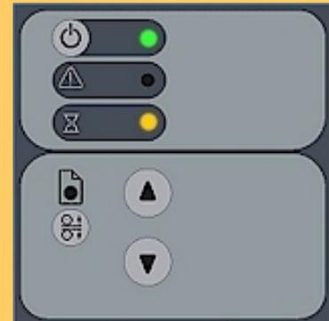
ハードの電源をオンにした場合は、初期化シーケンスが完了すると、電源LED（緑）と待機LED（黄色）は点灯したままで、残りのLEDは消灯します。この状態になった場合、スキャナのランププロファイル、ステッチング、および白黒ポイントの自動調節が実行されていることを示します。
