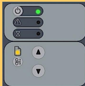
厚い原稿をスキャンする準備が完了すると、用紙セット完了LEDが黄色で点灯します。圧力プラテンが下がり、原稿がスキャナの正しい位置に取り付けられます。
