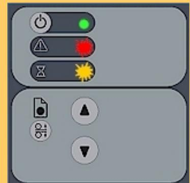
診断LEDと待機LEDの両方が同時に点滅している場合は、スキャン領域のクリーニングとカメラのキャリブレーションを行う必要があります。詳細については「[保守手順 \(クリーニング、キャリブレーション\)](#)」を参照してください。
