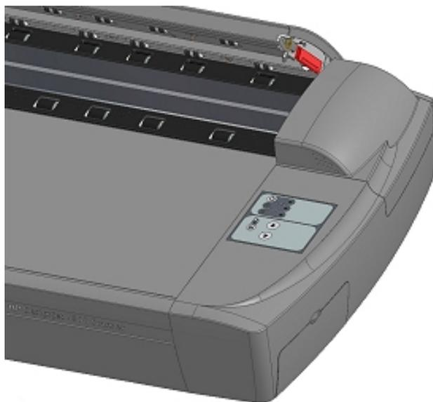
4. カバーの右端に赤いストリップがあります。赤いストリップを取り外して、白いプラテンの端が見えるようにします。
