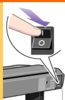
スキャナの背面にある電源ケーブルをコンセントに差し込み、背面の電源スイッチをオンにしてください。スキャナのセルフテスト処理が始まり、初期化シーケンスが開始されます(下記参照)。
