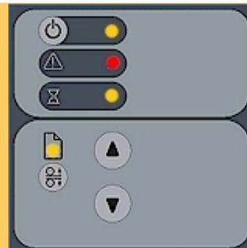
スキャナの背面にある電源スイッチをオンしてハードの電源を入れた場合、スキャナの初期化シーケンスが実行されます。上の図のように、すべてのLEDが点灯します。
