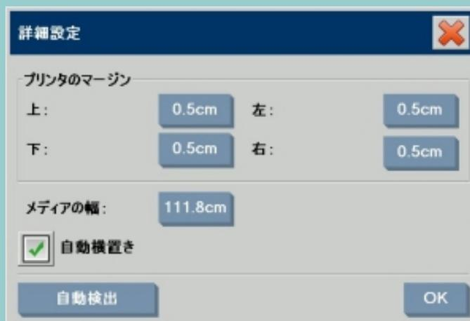
1. **起動時** - プログラムはプリンタ ドライバに保存されたメディア幅の値を設定します。これは通常はプリンタで使用できる最大出力幅です。プリンタの最大幅より狭いロール紙を使用している場合は、この幅を手動で変更する必要があります。[セットアップ] タブ -> [プリンタ] -> [ツール] ボタン -> [詳細設定] ダイアログを開きます。[メディアの幅] ボタンを押し、オンスクリーン キーボードから新しい値を入力し、キーボードのEnterキーを押して終了します。メディア幅の値が [メディアの幅] ボタンに表示されます。
