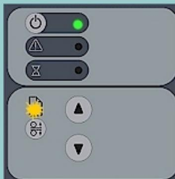
2. 原稿を挿入できる位置に圧力プラテンが持ち上がるまで、用紙送りボタン (上向き矢印) を押し続けます。厚い原稿を用紙フィーダにまっすぐに差し込みます。
