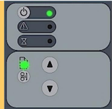
スキャン中は用紙セット完了LEDが点滅します。
