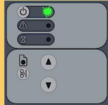
WIDSystemで定義された電源オフ時間になり、スキャナの電源が自動的にオフになる場合、その前に電源LEDが緑色で点滅します。
