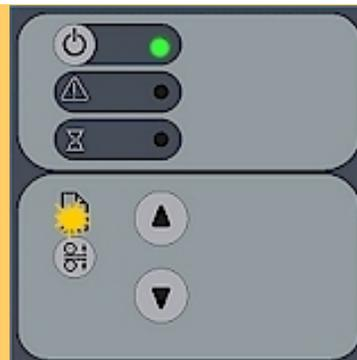
ATAC キー
