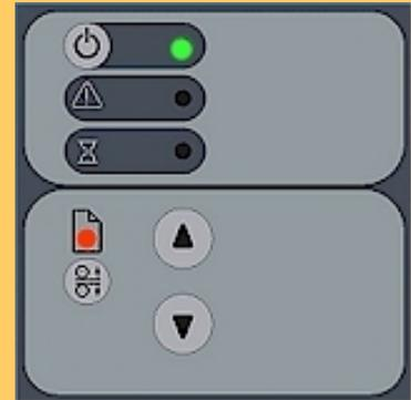
用紙セット完了インジケータが赤色で点灯する場合は、スキャナが厚い原稿用の設定になっている (圧力プラテンが上がっている) のに原稿が検出されないことを示します。
