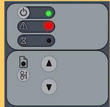
診断LEDは、スキャナのセルフテストの結果ステータスを示します。診断LEDが点滅しない場合は、スキャナのセルフテスト処理でエラーは検出されなかったことを示します。
