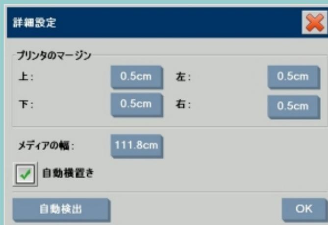
1. **起動時** - 現在プリンタに取り付けられているロール紙の幅がプログラムによって自動的に検出されます。この値は、[セットアップ] タブ -> [プリンタ] -> [ツール] ボタン -> [詳細設定] ダイアログの [メディアの幅] ボタンに表示されます。
