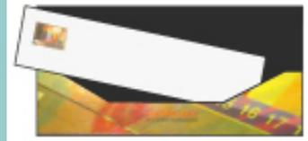
ウィザードにより、スキャナに付属されていた保守シートを挿入するように求められます。シートは、印刷面を下向きにして挿入する必要があります。シートの中心矢印をスキャナの中心矢印に揃えて、シートをスキャナに給紙します。
