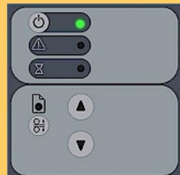
待機LEDが消灯し、電源LEDのみが緑色で点灯している場合は、自動調節が完了し、いつでもスキャンできる状態になったことを示します。
