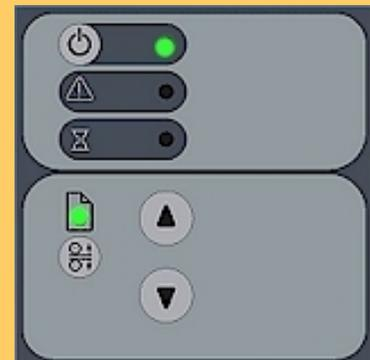
標準的な厚さの原稿を挿入スロットに正しく取り付けると、用紙セット完了LEDが緑色で点灯します。原稿がスキャン開始位置に送られる時点でも緑色で点灯しています。
