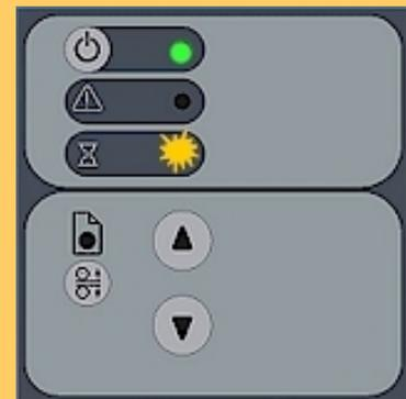
待機LEDが点滅 (診断LEDは消灯したままで) している場合は、スキャナの自動調節が必要にもかかわらず実行できない状態になっていることを示します。自動調節は、システム内部を最適で安定した状態に保つために必要です。
