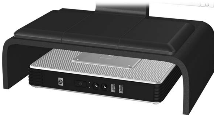
Figure D-3 En dessous du socle d'un moniteur
