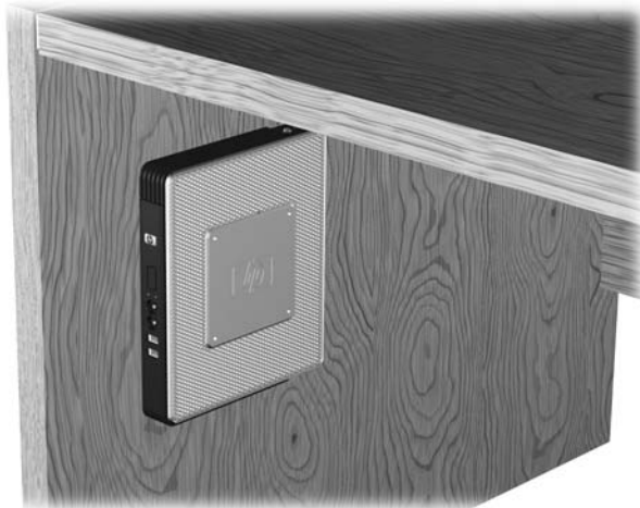
Figure C-8 Client léger installé sous un bureau
