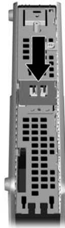
Figure 2-7 Ports USB dans le compartiment USB sécurisé
