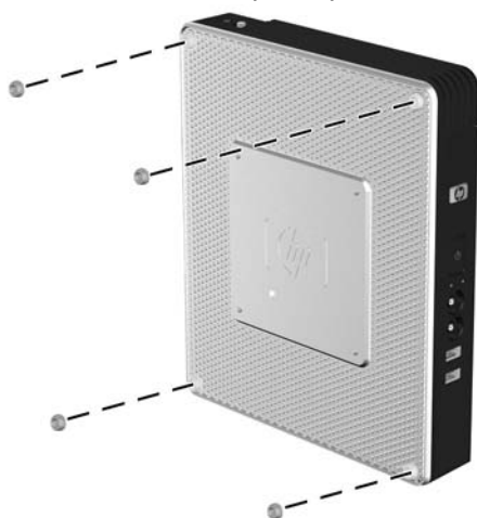
Figure 1-6 Installation des pieds protecteurs
