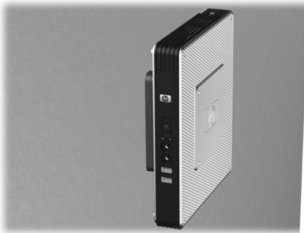
Figure C-7 Client léger monté sur un mur
