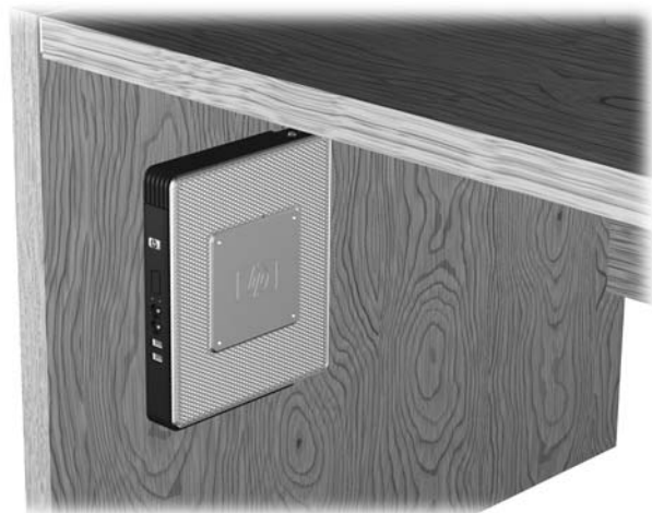
图 C-8 安装在桌子下面的瘦客户机
