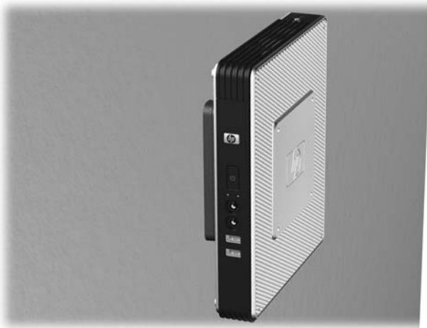
圖示 C-7 裝載在牆上的精簡型電腦
