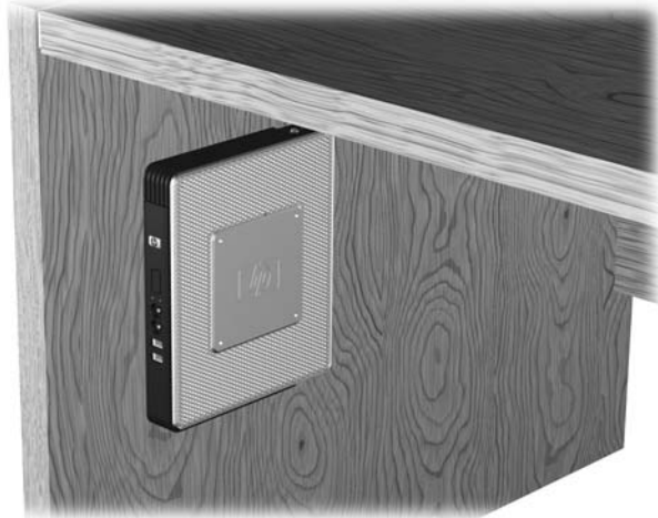
圖示 C-8 安裝在書桌下的精簡型電腦
