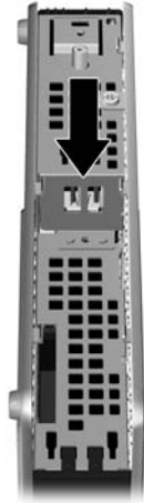
圖示 2-7 安全 USB 區間的 USB 連接埠
