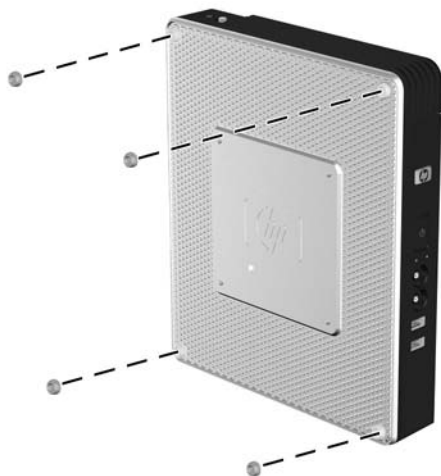
圖示 1-6 安裝橡膠腳座
