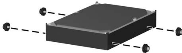
그림 2-28 하드 드라이브 유도 나사 설치
