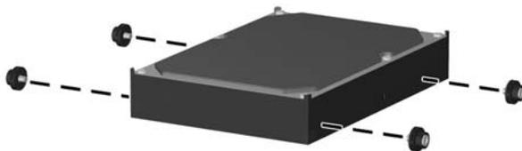
12. Alinhe os parafusos-guia com os slots no chassi do compartimento de unidade, pressione a unidade de disco rígido no compartimento, em seguida deslize a unidade para trás até trava-la no lugar.
