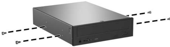
9. Posicione os parafusos-guia na unidade nos slots J do compartimento. Em seguida, deslize a unidade na direção frontal do computador até que ela trave no local.
