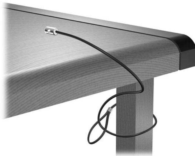
2. Passe os cabos do mouse e do teclado através do bloqueio.
