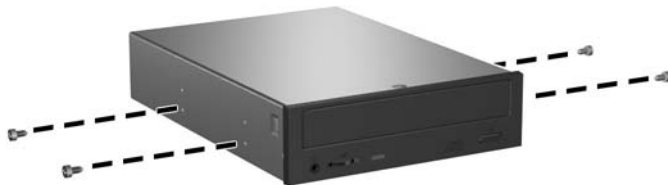
图 2-21 安装导向螺钉（所示为光驱）
