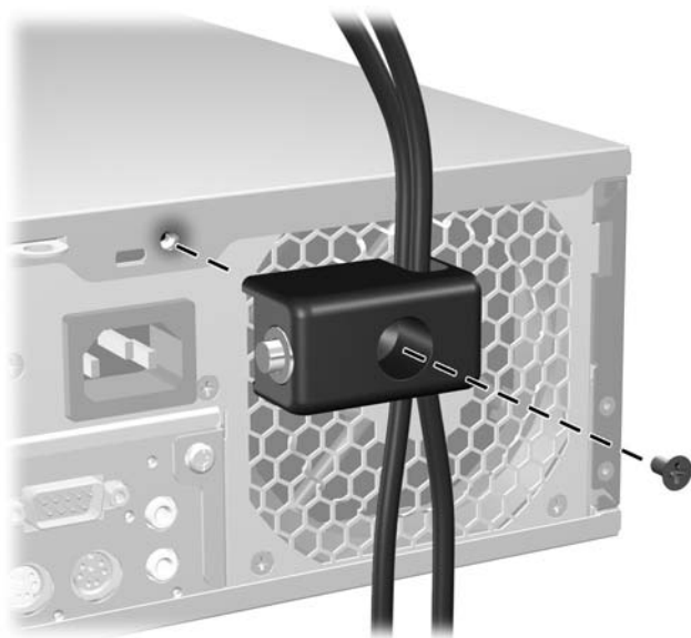
图 C-5 将钳锁固定到机箱上
