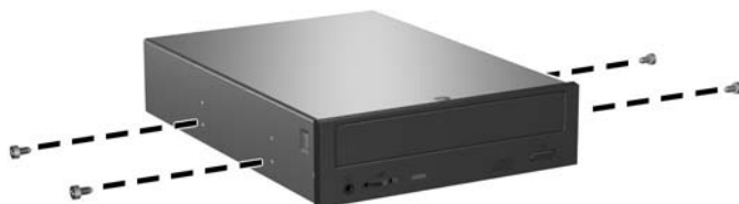
Obrázek 2-26 Instalace vodících šroubů do optické jednotky
