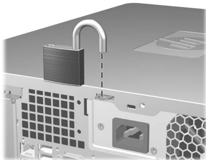
Obrázek C-2 Instalace visacího zámku
