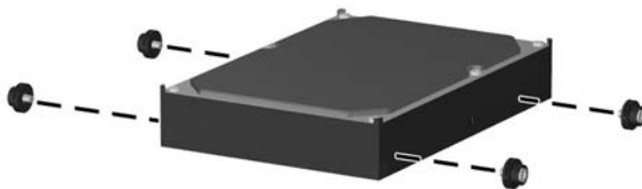
Obrázek 2-39 Montáž vodicích šroubů pevného disku
