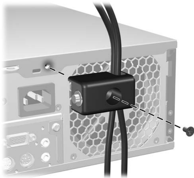
Obrázek C-5 Přichycení zámku k rámu
