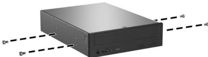
Figur 2-21 Isætning af styreskruerne (optisk drev vist)
