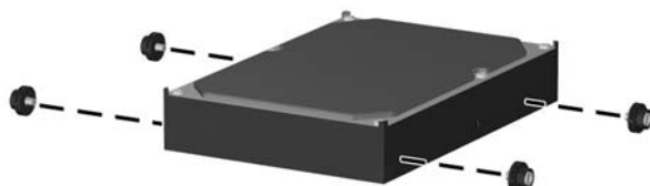
Figur 2-28 Installation af styreskruer til harddisken
