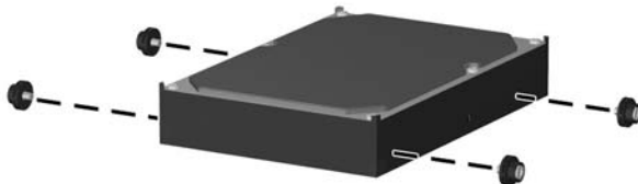
Figure 2-28 Installation des vis de guidage de disque dur
